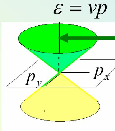
$$\hat{H}_1 = v \begin{pmatrix} 0 & \pi^+ \\ \pi & 0 \end{pmatrix} = v \vec{\sigma} \cdot \vec{p} = v p \vec{\sigma} \cdot \vec{n}$$
